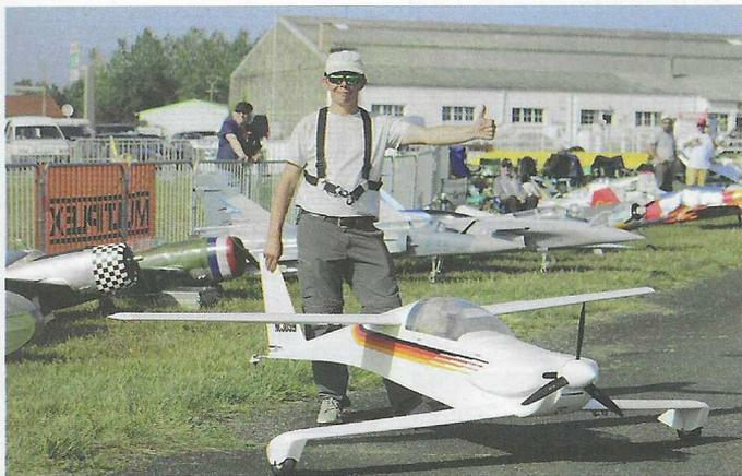
Erwan Plu avec un engin plutôt atypique, le Quickie. L'échelle est au demi et il est animé par un moteur de 80 cm<sup>3</sup>. Vous remarquerez le train placé au bout des ailes inférieures.
