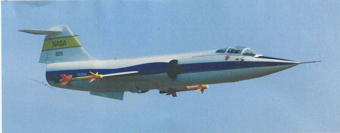
**Le célèbre F104 Starfighter de Ronan Floch : une machine pour le moins impressionnante en vol. La turbine est une Ft 300 de 30 kg de poussée, l'envergure est de 1,66 m pour une longueur de 4,40 m, la masse au décollage est de 30 kg.**
